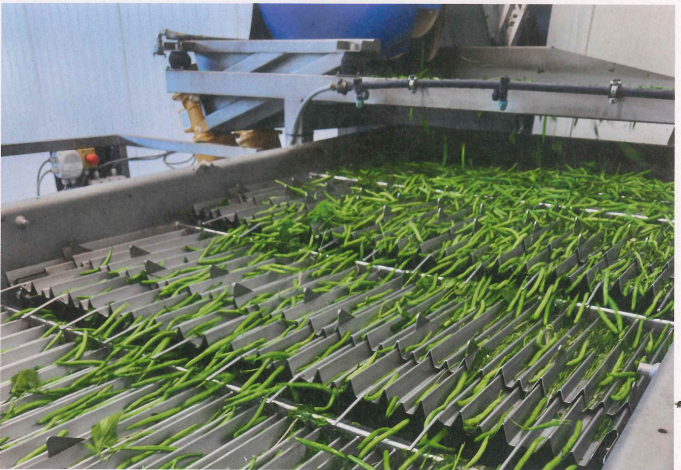
Der Längenkalibrierer stellt die Weichen: ab in den Frischkonsum oder in die Dörranlage.
