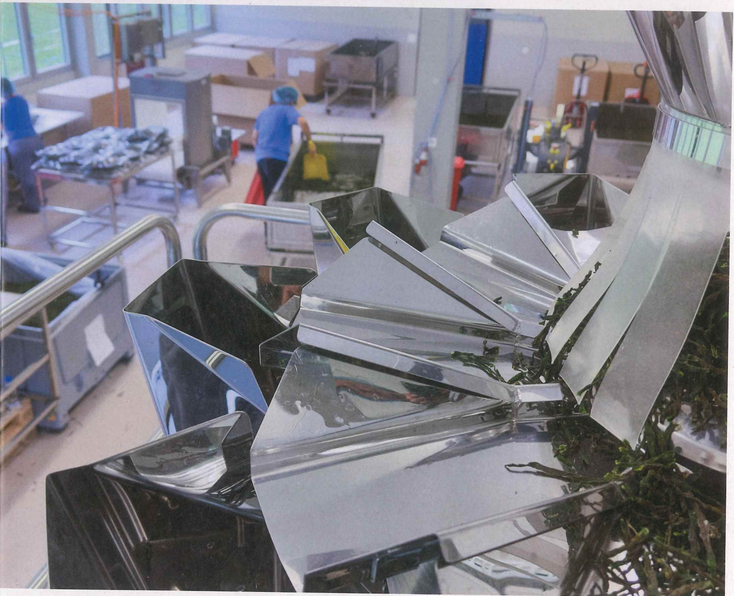
Nach der genauen Schlusskontrolle sind die Dörrbohnen parat fürs Abfüllen durch die Mehrkopfwage in 100-Gramm-Beutel, per Hand in 1- und 2-Kilo-Säcke.
